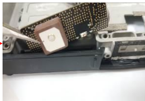
Remove the GPS modules(S.S.T.)
