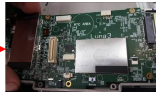
Remove the PCBA Mainboard(S.S.T.)
