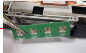
Remove the PCBA button board(S.S.T.)
