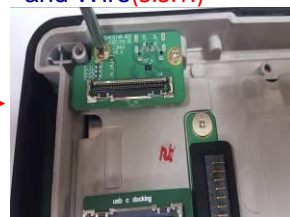
Separate the PCBA USBC Docking Board(S.S.T.)
